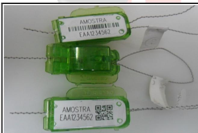
**Amostra após ensaio de efeitos climáticos -
