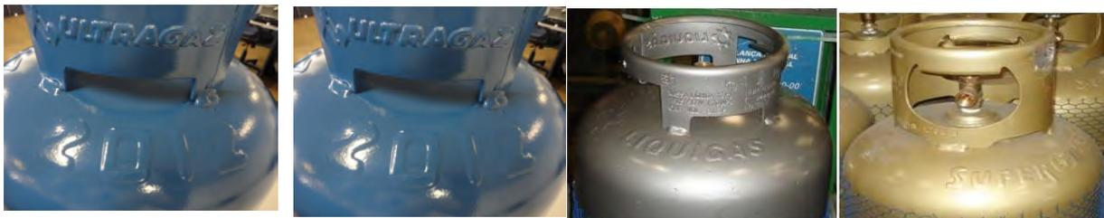
Fig. Data de fabricação e marca da Distribuidora marcado em alto relevo no cilindro
