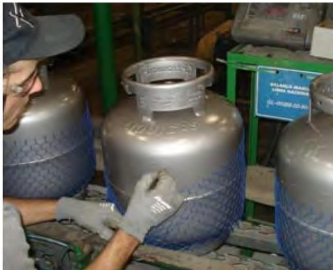
Assim que a identificação por transponder for implantada em todos os cilindros em produção, este cargo pode ser eliminado pois bastaria uma balança eletrônica e a leitura da tara poderia ser feita eletronicamente e totalmente automatizada. Assim, o transponder é lido na estação, e o peso da tara é automaticamente gravado e relacionado ao número de identificação do transponder em um banco de dados ou em uma planilha Excel.
