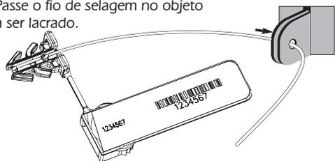
Passo o fio de selagem em volta da âncora e retorne pelo lado oposto de modo que fiquem alojados na canaleta central da âncora.
