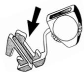
Se o fio de conexão romper-se, troque o selo. Fio quebrado pode significar violação.
