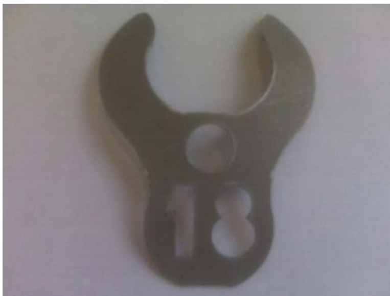
FIGURA 10 – PLAQUETA DE IDENTIFICAÇÃO COM O ANO DA PRÓXIMA REQUALIFICAÇÃO VAZADA
