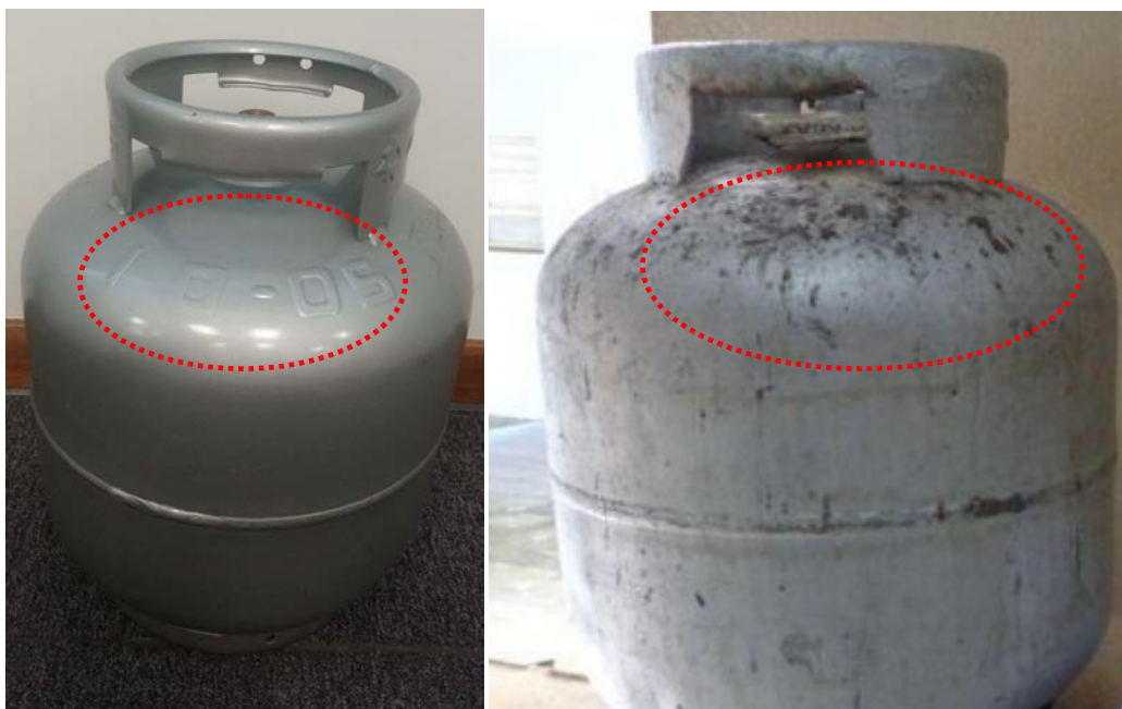
FIGURA 8 – DATA DE FABRICAÇÃO DE UM BOTIJÃO (LEGÍVEL VS. ILEGÍVEL)
